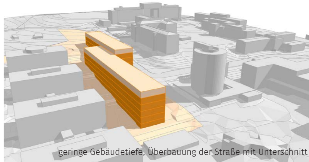
- Abstandsflächen zu gering, Anschließen an Bestand nicht möglich
