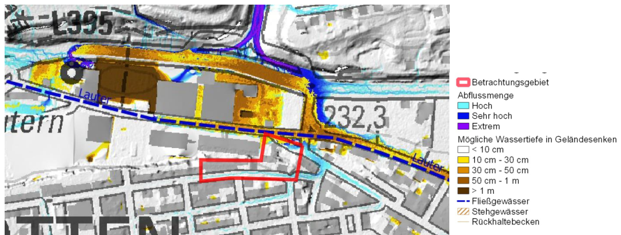
Abbildung 5: Auszug aus Starkregengefahrenkarte (SRI 7, 1 Stunde) ( T = 100 a, h_N = 55 mm), Kaiserslautern (Quelle: Stadtentwässerung Kaiserslautern AÖR)
